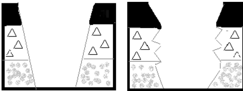
Figur 2 Eftersträva efter en jämn schaktvägg enligt figuren till vänster, ej enligt figuren till höger. Khalid Kamil 2017
